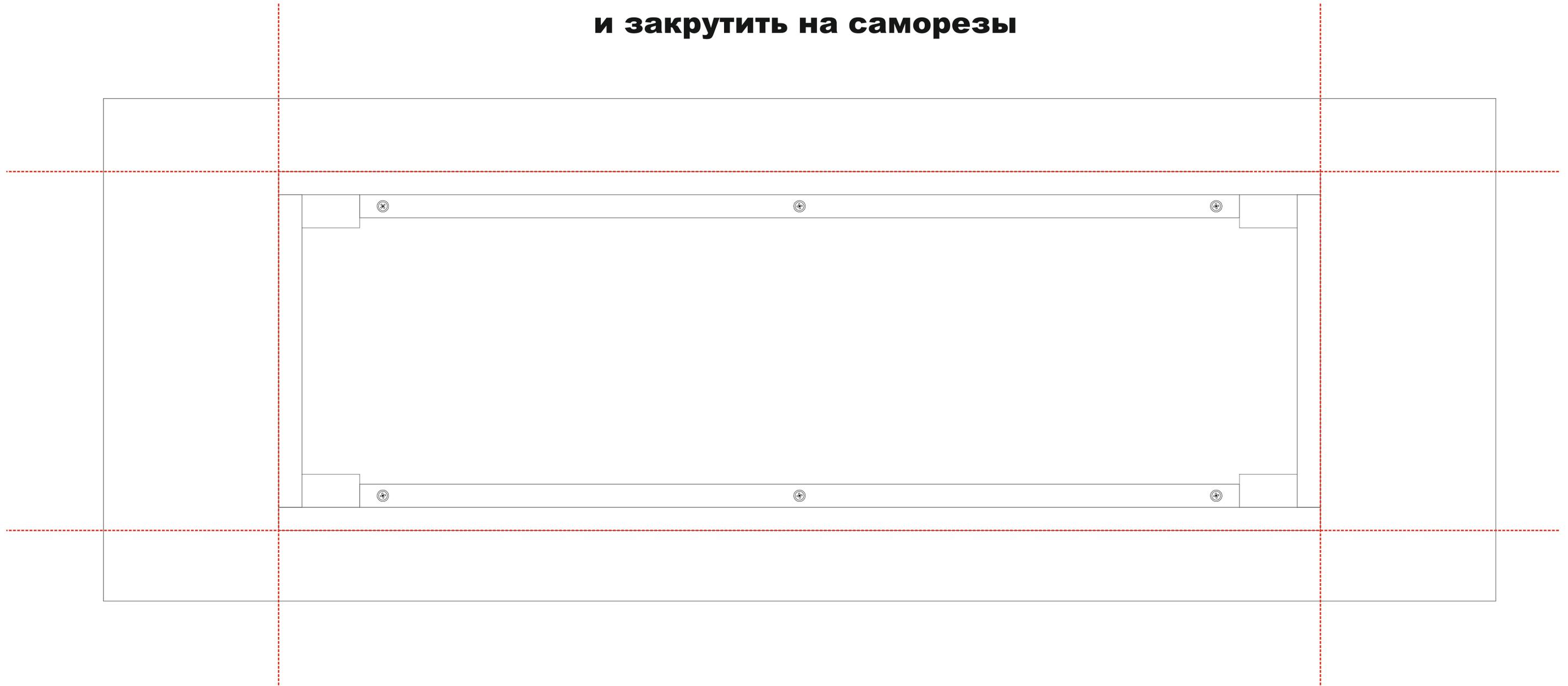
**Используйте саморезы из комплекта для фиксации каркаса ног на нижней детали корпуса .**
