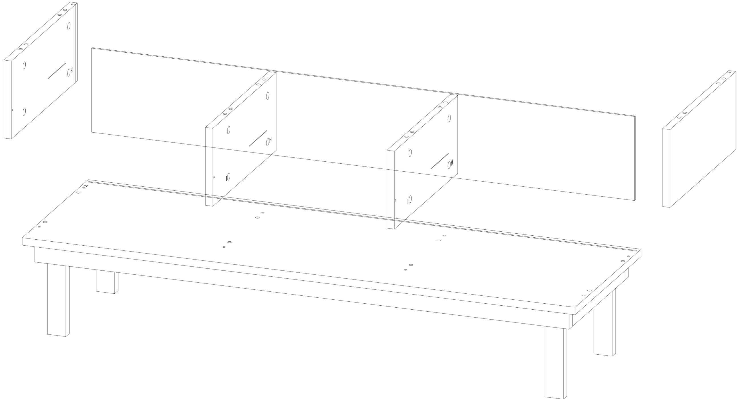
! Обязательно соблюдайте последовательность сборки в инструкции. Верхняя крышка корпуса устанавливается после монтажа задней стенки.
