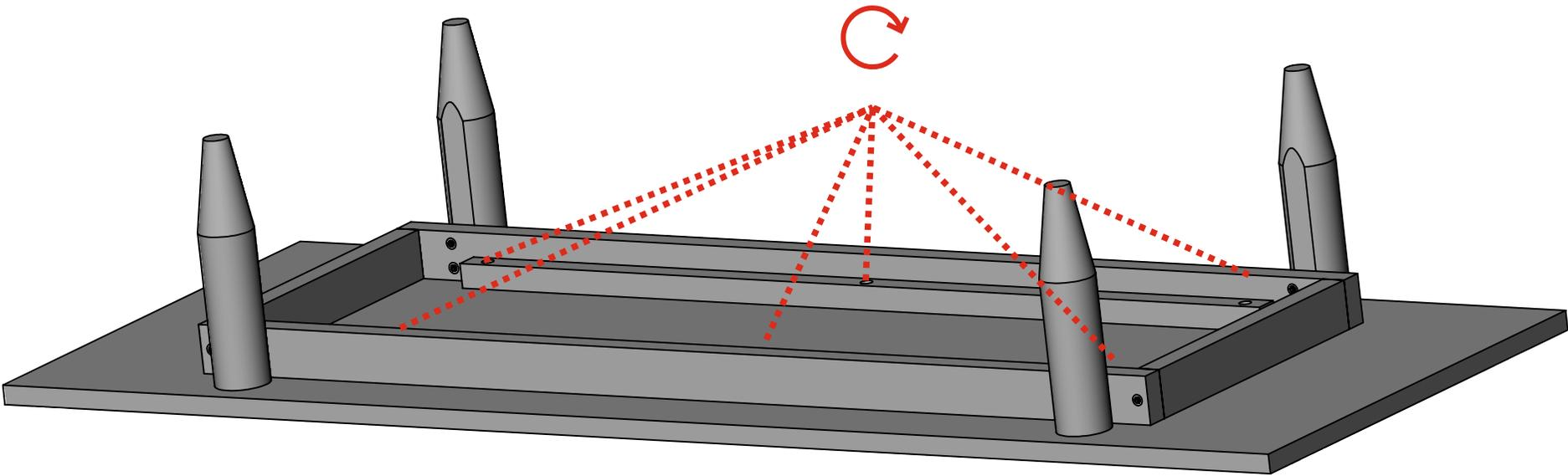
Корпус и ящики собираем на эксцентрикые стяжки
